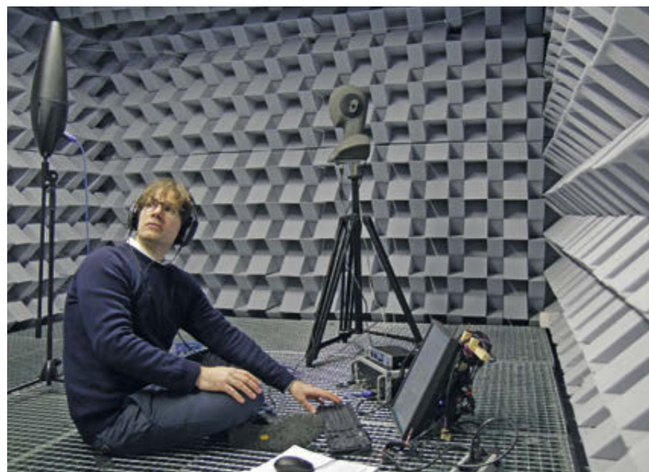
Kalibriermessung der abgestrahlten Schalleistung im reflexionsarmen Raum
