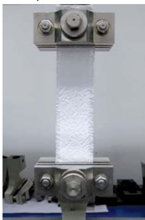
Abb. 1: Zugversuch am Normhandtuch
