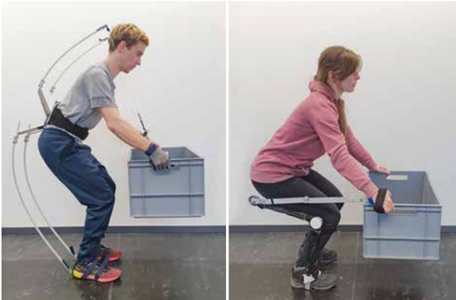
Erste Prototypen für das Exoskelett, das sich am Wirkprinzip des Heuschreckensprungs orientiert, sind fertig
